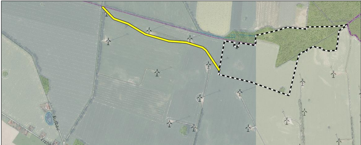
Abbildung 5 temporäre Erschließung zur Anlieferung der Schwerlastkomponenten über Lastverteilungsplatten
